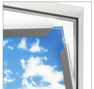
Elegant und schlicht wirkt das schmale Leuchttransparent ALU-It32 mit 32mm-Bautiefe für den Innenbereich. Die Konstruktion des Rahmens ermöglicht mit der Steckrahmen-Wechseltechnik ein einfaches Auswechseln des Motives. Starke 12V-LED-Strips mit 28,8 Watt pro Laufmeter, die auf der Kante einer 6mm-Streuscheibe positioniert sind, sorgen für sehr viel Licht. Viel Licht, das mit einem speziellen Verlaufs raster auf der Streuscheibe besser und gleichmäßig verteilt wird.
