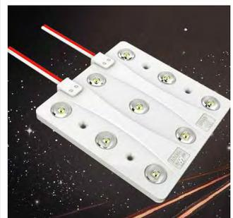
Die LED-Seitenlichtmodule XXL-G2 mit 12V/ 7W/ 6500K sind insbesondere zur wirtschaftlichen und homogenen Ausleuchtung von **grossformatigen Leuchttransparenten und Lichtwänden** sowie für **Profilbuchstaben ab einer Bautiefe 100mm - 180mm** geeignet. Mit IP68 sind die Module ausser-tauglich.
